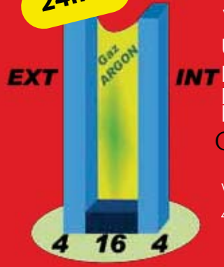
Vitrage Thermique renforcé 4-16-4 faible émissivité avec gaz argon
