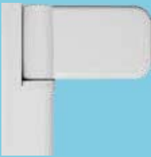
Simonswerk laquées 80 kg par paumelle 3 paumelles par porte réglage 3D : hauteur + latéral + compression
